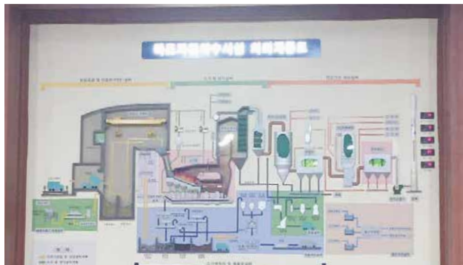
Rajah alir proses bagi Mapo Resources Recovery Plant yang menggunakan teknologi stoker dan rotary kiln.
